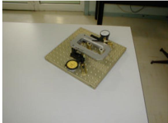
Montage d'autocontrôle associé au poste de production
