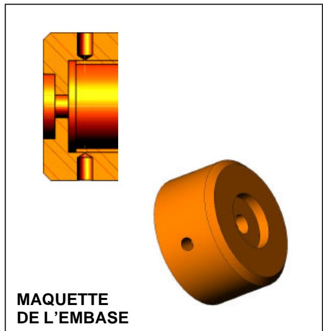
Les définitions numériques sont fournies, les mises en plan spécifiées également (voir ci-dessous). On envisage de réaliser la vis et l'embase dans le même brut (voir la nomenclature des phases du processus de réalisation ci-jointe).
