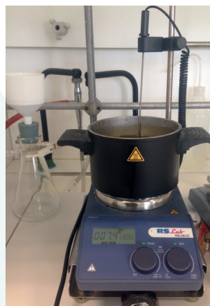
Montage pour chauffage : plaque chauffante et bain d'huile
