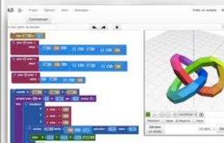
**BlocksCAD** fonctionne sur le même principe tout en permettant la construction des objets 3D à l'aide de transformations de l'espace.
