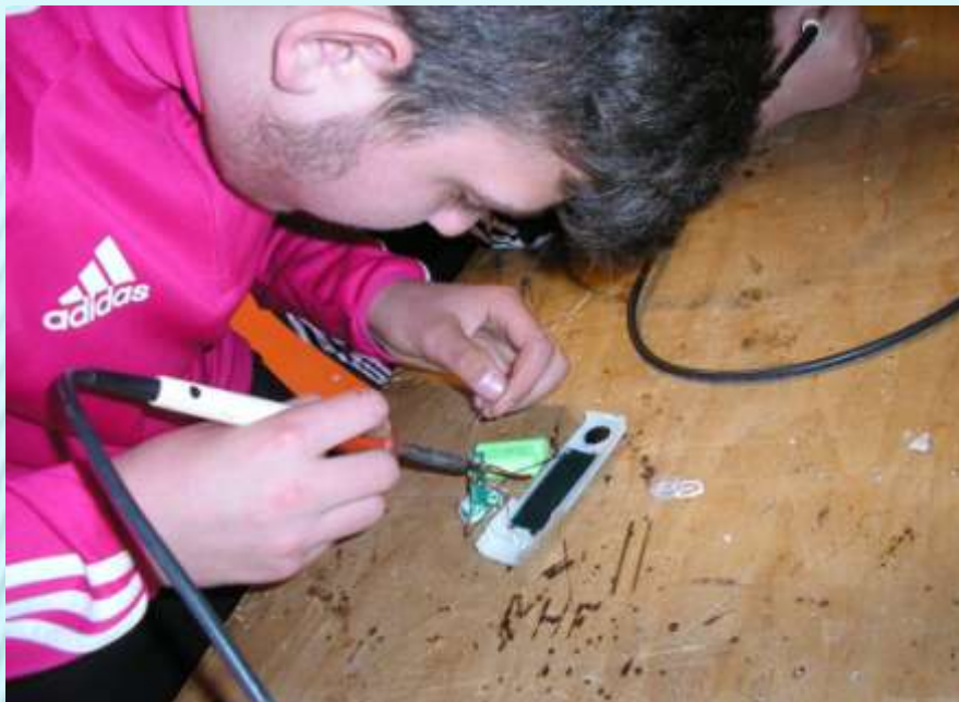
Soudure des différents éléments de la lampe solaire par les élèves de 5m6 en technologie
