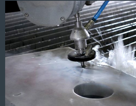
Principe du jet d'eau : eau additionnée de sable
