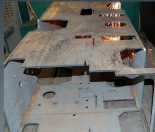
Exemples de découpe laser 3D (machine multi-axes)
