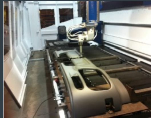
Exemples de découpe laser 3D (machine multi-axes)
