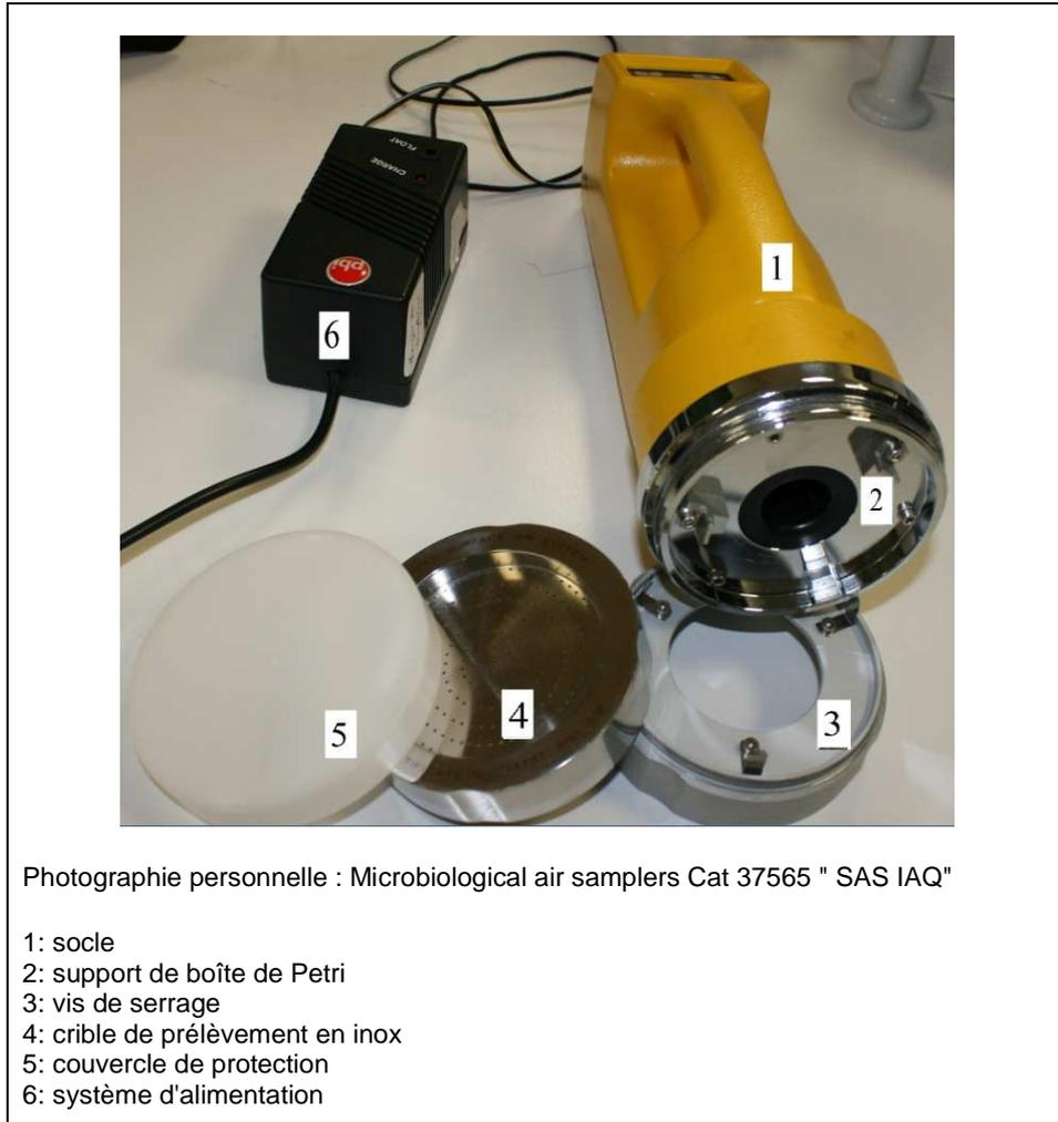
Le biocollecteur est constitué d'un système d'aspiration électrique (1 et 6). Une boîte de Petri contenant le milieu gélosé choisi est placée sur le support de boîte de Petri (2) et fixée à l'aide de la vis de serrage (3). Le crible perforé en inox autoclavable est vissé sur la vis de serrage. L'air est aspiré au travers de ce crible (4) et imprime le milieu gélosé (5).
