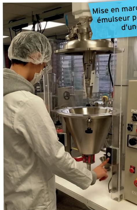
Mise en marche du mélangeur émulseur pour la fabrication d'une émulsion
