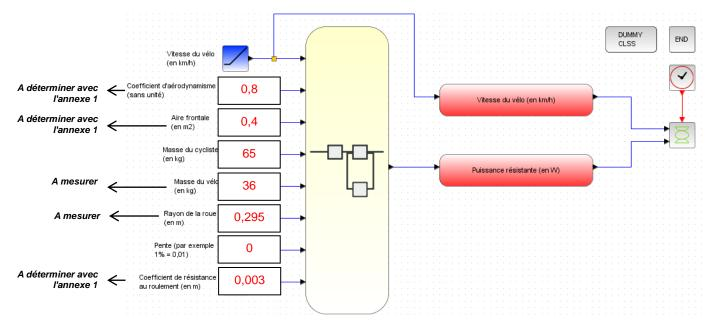
7) Ouvrir le logiciel de simulation Scilab 5.5.2, puis dans l'onglet application, cliquer Xcos, et à partir de la nouvelle fenêtre ouvrir le fichier " Modélisation puissance résistante " fourni.
